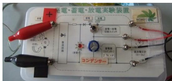
発電・蓄電・放電実験装置 (日立理科クラブ自作教具)
